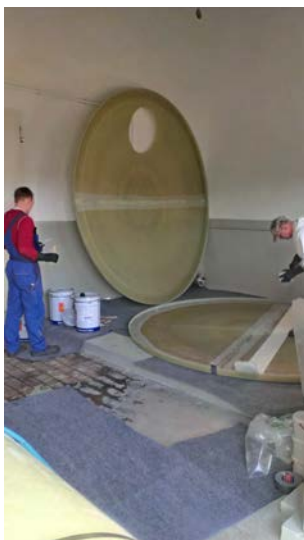
Boden und Deckel des GfK-Tanks
