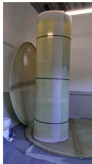
Aufgewickelte Wand des Tanks
